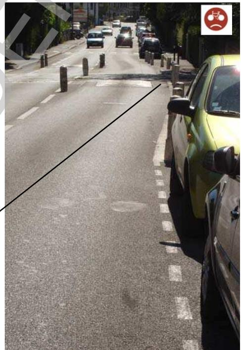
**Les plateaux**, dispositifs plus longs que les coussins, sont implantés sur toute la largeur de la chaussée afin de limiter les vitesses des Véhicules à moteur. Ils ne posent pas de problème insurmontable aux cyclistes à condition que l'angle d'attaque respecte le seuil zéro (*avis de la FFCT*).
